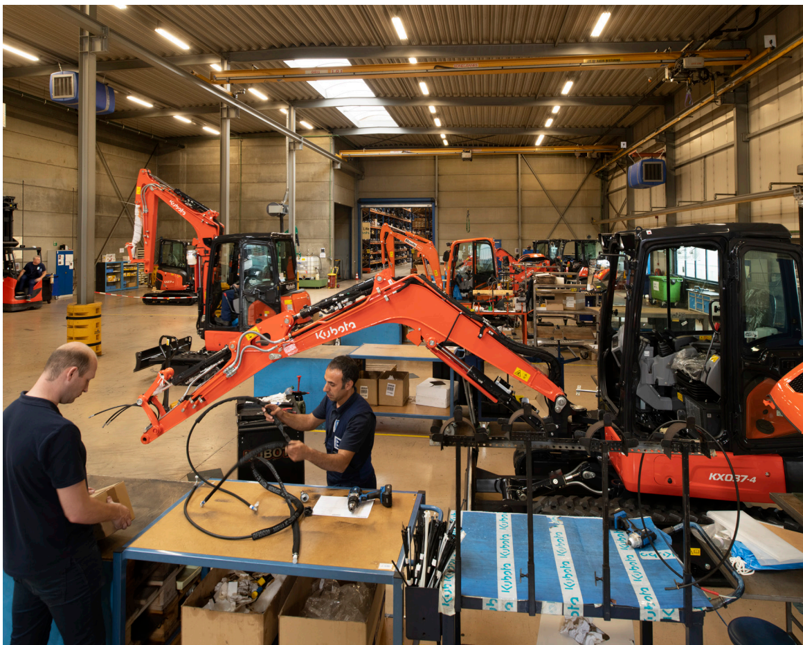
Broekman Logistics, Born. Eind-assemblage van graafmachines, uit internationaal geproduceerde onderdelen
