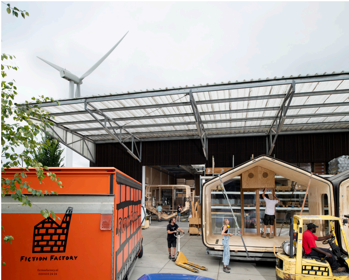
Wikkelhouse, Amsterdam. productie van prefab woningen uit karton, hout en andere grotendeels circulaire materialen, in combinatie met voor- en natransport
